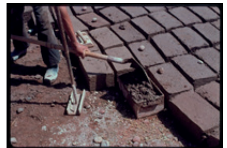
Fabrication de briques de terre crues appelées « adobe » au Maroc. Photo A.-S. Cléménçon
